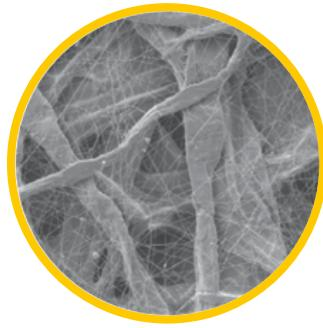
El medio de Ultra Alta Eficiencia está diseñado para satisfacer la necesidad de un mayor nivel de filtración y capacidad de retención de suciedad.
