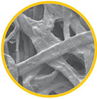
El medio filtrante de eficiencia estándar se adapta bien en aplicaciones de uso normal, proporcionando mayor protección del motor y previene el tiempo de inactividad de los equipos.
