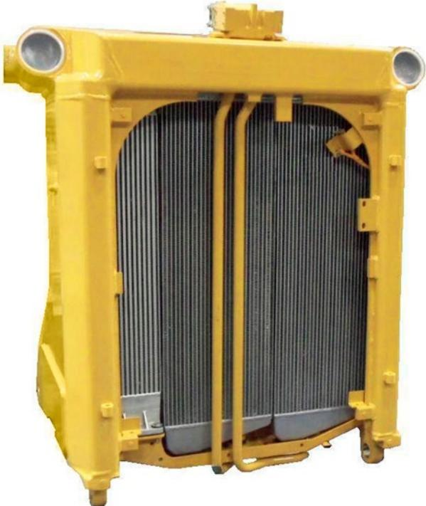
El sistema de enfriamiento del D6T es duradero y eficiente, utiliza la estructura de placa de barra de aluminio de los núcleos del radiador y el ATAAC (Air To Air After Cooler, Posenfriador Aire a Aire). La placa de barra de aluminio proporciona durabilidad y permite alta transferencia de calor y resistencia superior a la corrosión. El radiador se compone de núcleos dobles de la unidad que funcionan en conjunto como un solo intercambiador de calor.
