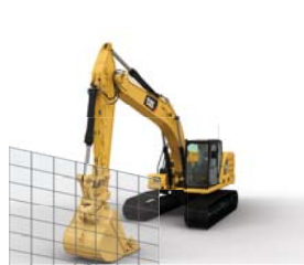
PROTECCIÓN ELECTRÓNICA AL FRENTE (E-WALL FORWARD)
