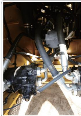
El sistema hidrostático actualizado no solo aprovecha el accionamiento hidrostático automático de doble ruta de Caterpillar con tecnología de control electrónico de la tercera generación TTT, sino que también aumenta la eficiencia y la confiabilidad.
